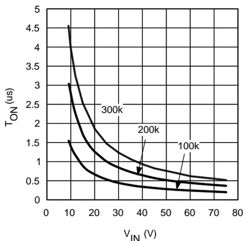
Figure 9.  $V_{IN}$  vs  $T_{ON}$
